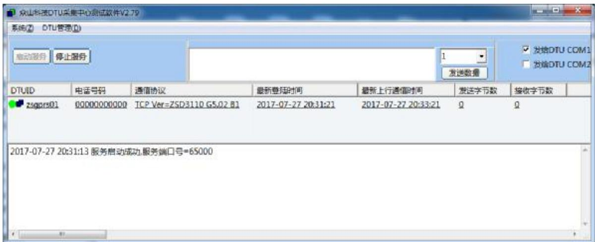
待DTU登录到数据中心后，点击设置程序界面“透明传输测试”进入透明模式界面：
