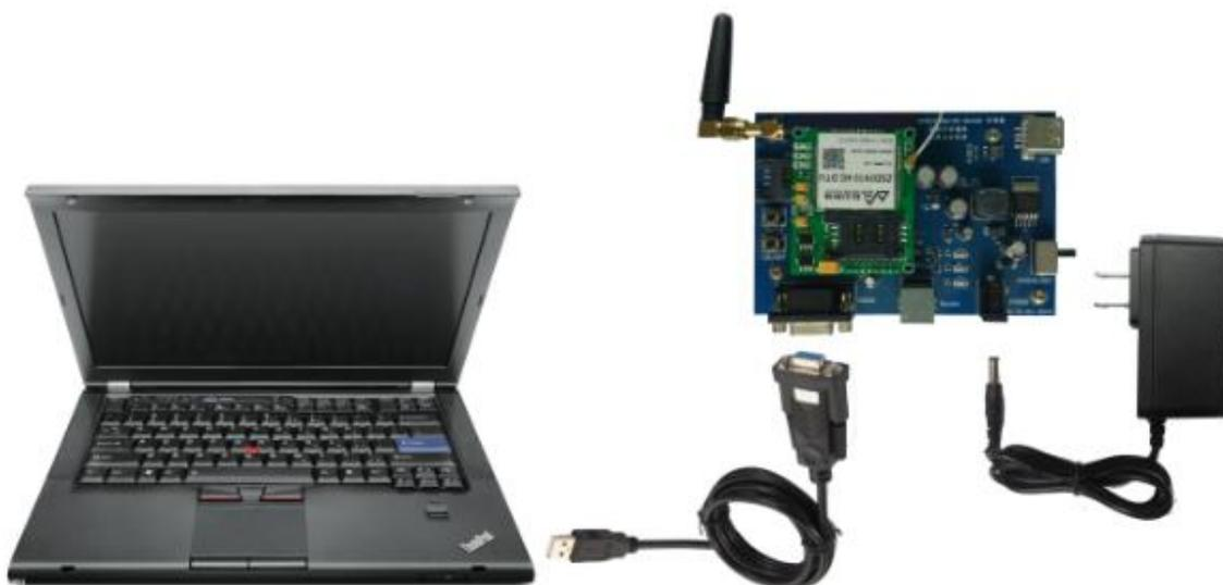
DTU 测试连接示意图
