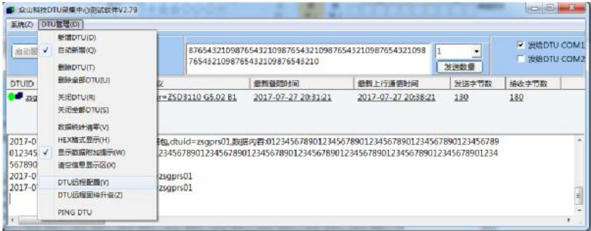
点击上方下拉菜单“DTU 管理 (D)”、然后点击“DTU 远程配置 (Y)”出现如下远程参数配置界面，参数配置方法同本地参数配置。
