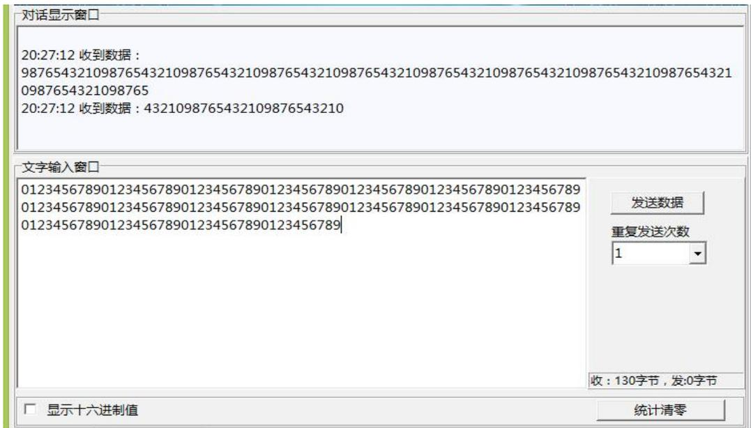
正常情况下，几秒之内数据中心就能接收到DTU上发的数据，用户可以在数据中心信息显示框中查看接收到的数据。
