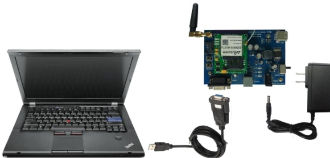
DTU 测试连接示意图
